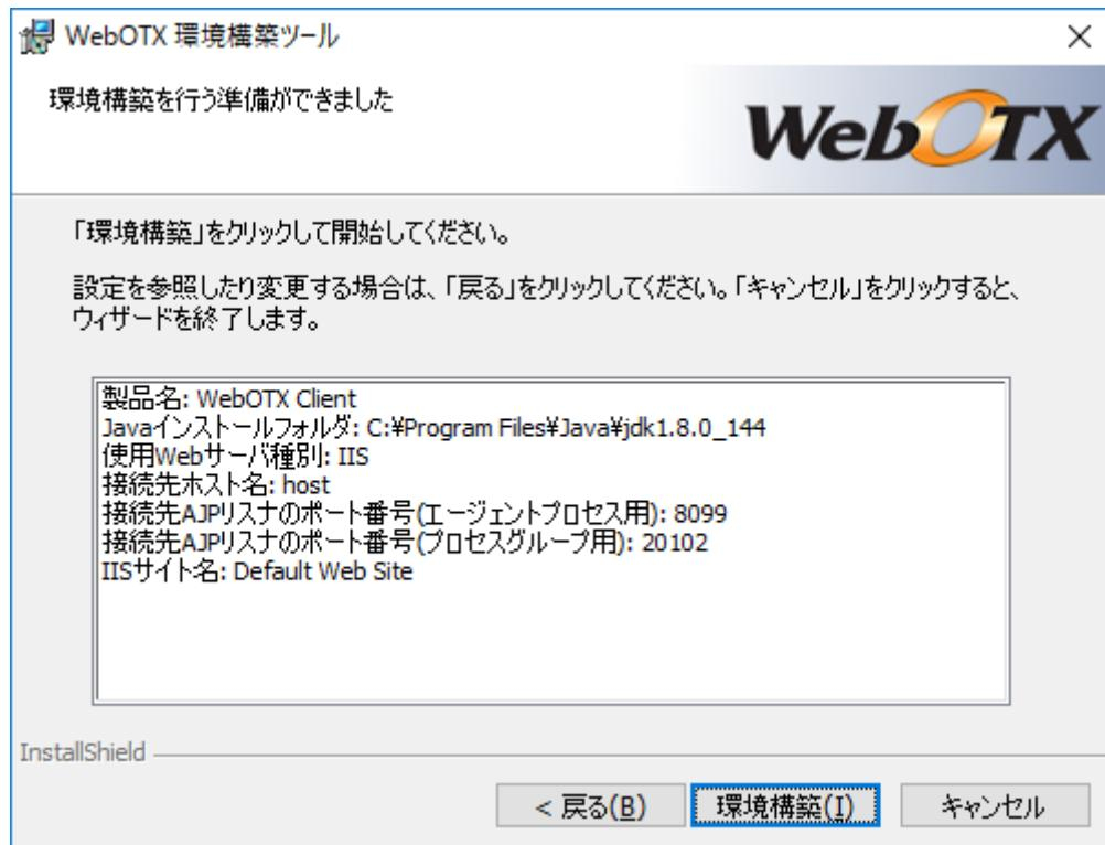
(8) WebOTX の環境構築を行うため、以下の画面が表示されます。画面が終了するまでしばらくお待ちください。環境構築の実行結果は、<WebOTX インストールフォルダ>\ant\_setup.log で確認できます。
